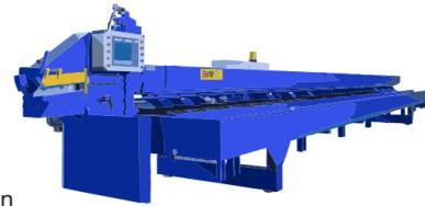
HBSA - Halbautomatischer Betonstahl-SchneideAutomat zur wirtschaftlichen Bearbeitung von Betonstahlstäben mit einer Festigkeit von 850 Nm/mm<sup>2</sup>.
